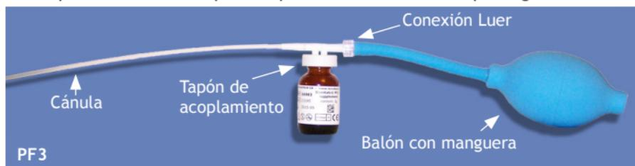
garantiza un cierre hermético y sellado necesarios para una perfecta funcionalidad del sistema. Fije el balón al tapón de acoplamiento con la conexión Luer. Asegúrese que todos los componentes estén bien montados.
